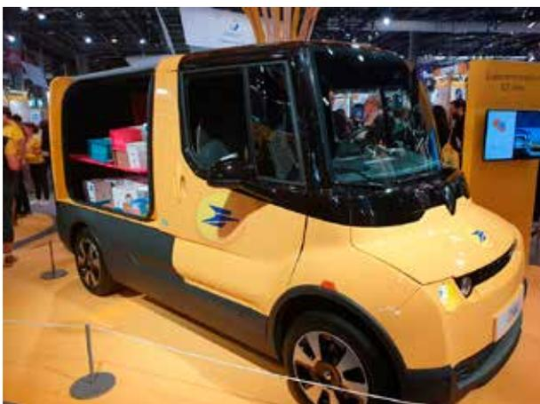
L'EZ-Flex est un véhicule utilitaire spécialement pensé pour les livraisons propres en milieu urbain : moteur 100% électrique (150 km d'autonomie), dimensions compactes, capacité d'emport de 3 mètres cubes, accès facilité au poste de conduite, chargement-déchargement par vantaux latéraux (optimisation du volume utile, sécurité de la livraison), modularité de l'espace de chargement (fourgonnette-pickup), etc.
