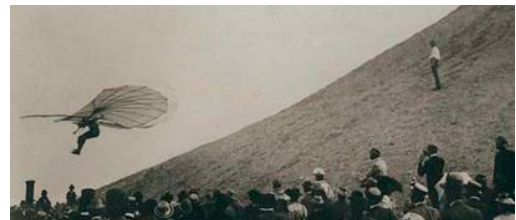
En 1894, l'allemand Otto LILIENTHAL, parvient à mettre au point un planeur capable de voler sur 400m . Ses prototypes étaient réalisés à partir de nervures de bambous entoilés de coton. Il fait aménager une colline de 30m près de chez lui. Il effectua plus de 2500 vols planés.
